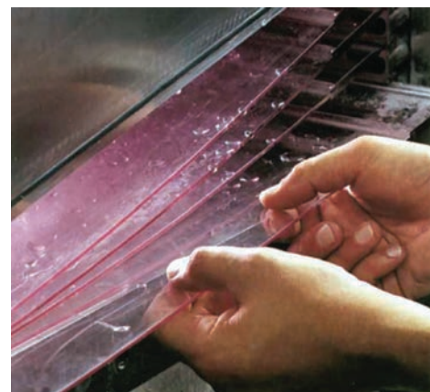
Figura 2. Las Polysheets están hechas de policarbonato (Lexan)
